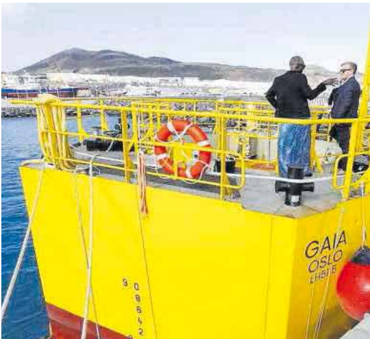
Prototipo de desalinizadora flotante instalada en el puerto de Las Palmas de Gran Canaria. Se alimenta con la energía de las olas.
